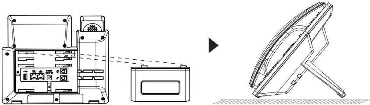
图 3: GRP2624 上的电话支架和安装槽
