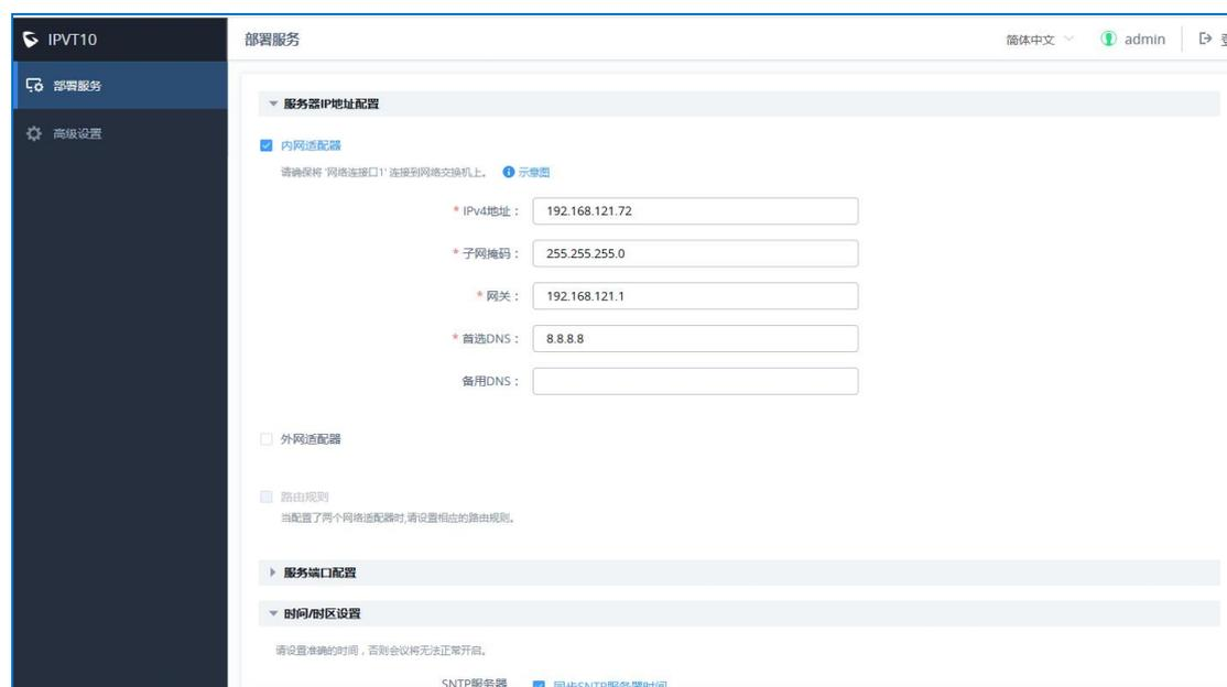
**图表 9 配置服务器 IP 地址-内网适配器**
